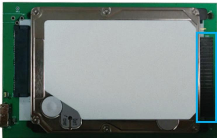
4. 付属の4本のドライブ取付用ネジでドライブを所定の位置に固定します。
