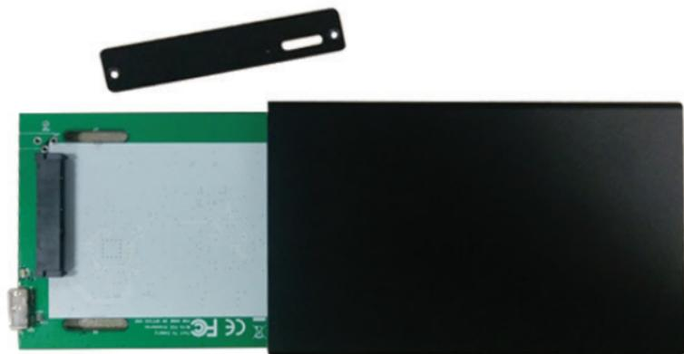
3. 2.5インチSATA SSD/HDDをドライブトレイに接続します。
